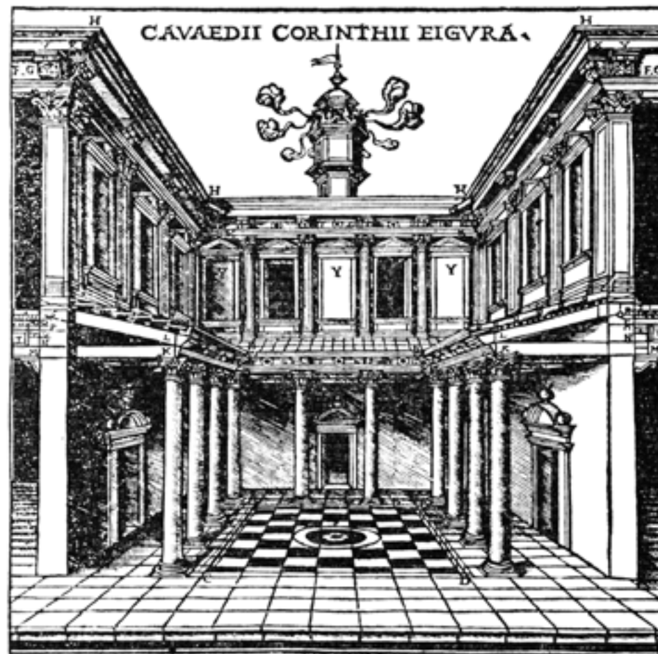
Vitruvius utgår i sin bostadsplanering från det s.k. patricierhuset med en central atriumgård, kring vilken alla husets utrymmen placeras i två våningar. Patricierhuset eller atriumhuset fascinerar fortfarande även nutida arkitekter. Illustrationen är troligtvis utförd av Andrea Palladio.
